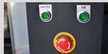
Seta de parada de emergencia
