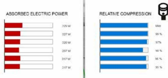
Dans ce test effectué par l'un de nos ateliers, on peut voir qu'après le traitement de décalaminage, la compression des cylindres a augmenté d'environ 30% et que le problème de compression présent dans le piston 4 a pratiquement disparu.
